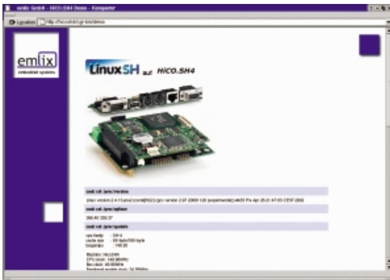
Ethernet Schnittstelle aktiviert - ein Webserver mit Statusinformationen ist im Netz
