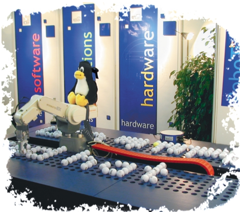
Steuerung eines Bestückungsroboters per emlixBOX, die sich über ein Web-Interface aus dem Internet ansprechen lässt
